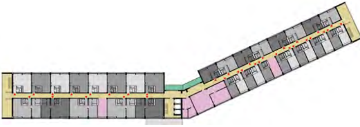
Fig. 10. Planta tipo de uno de los dos bloques residenciales de la Casa Comuna experimental (Novye Cheremushki Kvartal) de Moscú (N.A. Osterman, 1965-1969). Dibujo de C.D. Sirvent, publicado en su Tesis doctoral. [ver nota 6]
