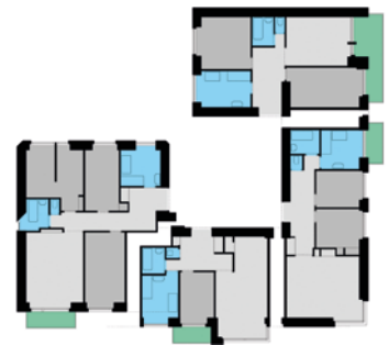
Fig. 4. Esquema explosionado de apartamentos, planta-tipo de la casa-comuna Gosstrakh, Moscú (M. Ginzburgú, 1926-1927). Posteriormente convertidos en una kommunalka . En azul se marcan las zonas compartidas de cada apartamento: baño y cocina. Dibujo de C.D. Sirvent, publicado en su Tesis doctoral. (6)
