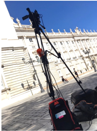
Imagen 1. Dispositivo de cámara y mochila de emisión
